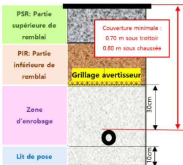
Après l'aménagement du lit de pose de 0,10 m au fond de la tranchée (1<sup>er</sup> sablage de 0/6,3 mm), le remblai (assemblages exceptés) doit suivre immédiatement la pose du tube PE afin de constituer la meilleure immobilisation de celui-ci dans la tranchée commune.
